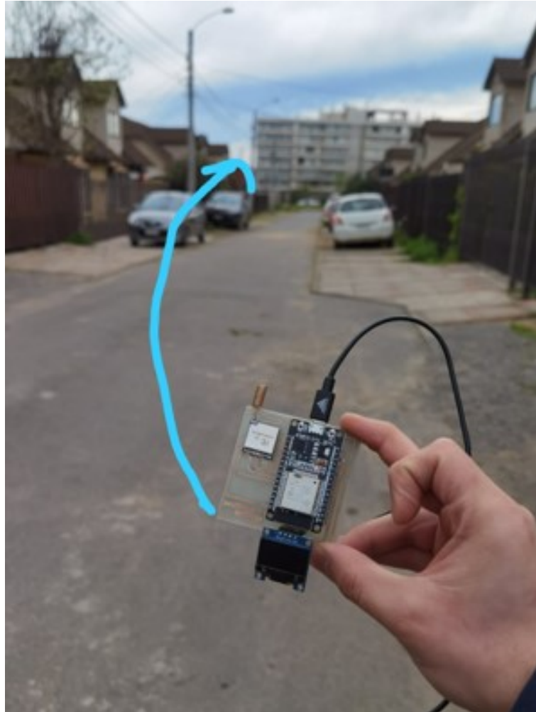
Figura D.4: Prueba de distancia a 500 metros rectos de radio frecuencia en ciudad
