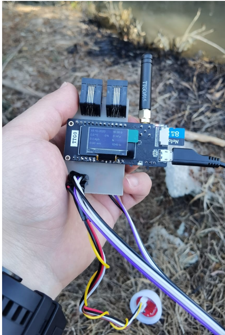
Figura D.2: Prueba de distancia a 3 kilómetros de radio frecuencia en campo
