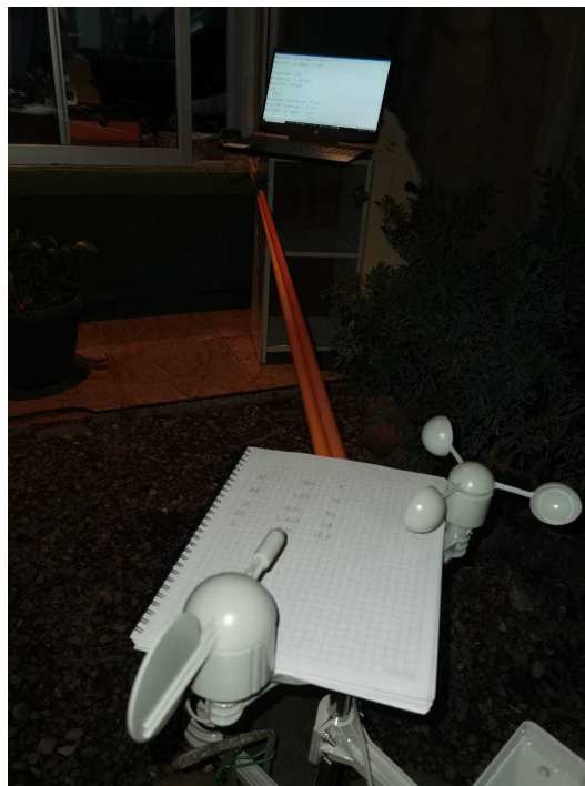
Figura C.1: Calibración de la dirección del viento a 3.3V
