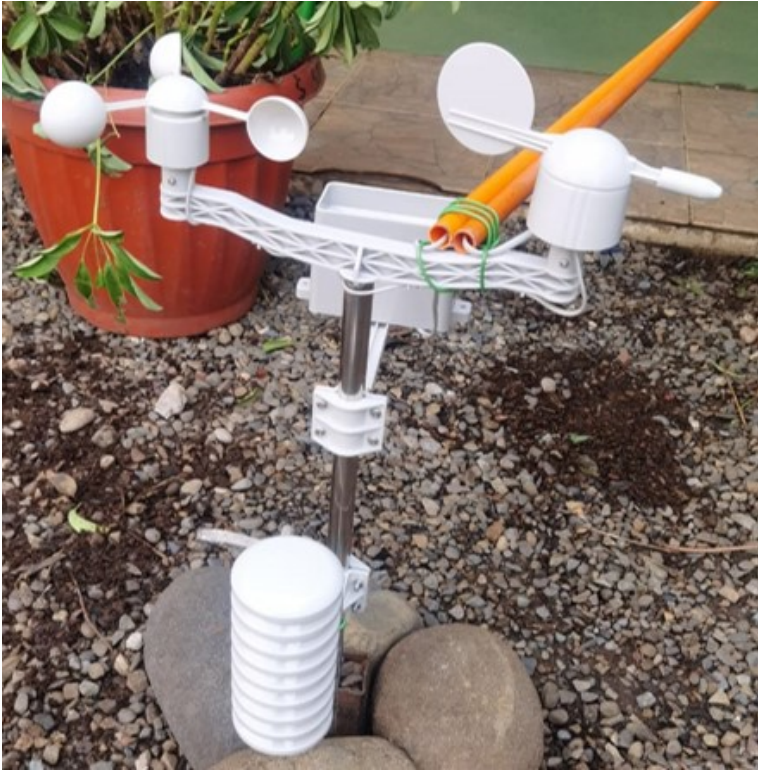
Figura B.4: Primer armado sensores de viento y lluvia
