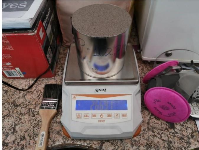
Ilustración 4-8 Determinación de densidad máxima seca (Propia, 2020)
