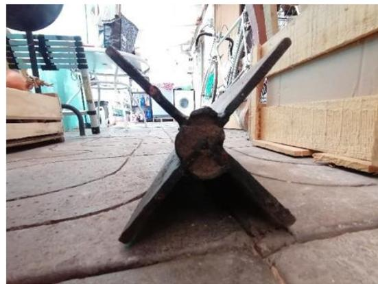
Ilustración 4-11 Ensayos de veleta con arena  $S_R = 100\%$  (Propia, 2020)
