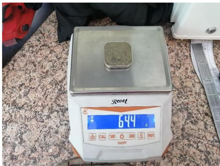
*Ilustración 4-6 Peso de la muestra húmeda del depósito de relaves (Propia, 2020)*
