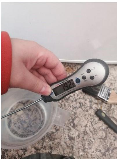
*Ilustración 4-2 Toma de temperatura para obtener el volumen del molde 1 (Propia, 2020)*
