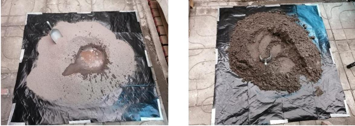
Ilustración 4-10 Homogeneización del suelo arenoso (Propia, 2020)
