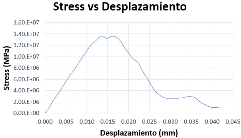
*Figura 19.* Curva Stress-Desplazamiento para el modelo heterogeneo sin fracturas. El valor máximo de stress alcanzado es de 13.6 MPa, sobreestimando la capacidad de la muestra.
