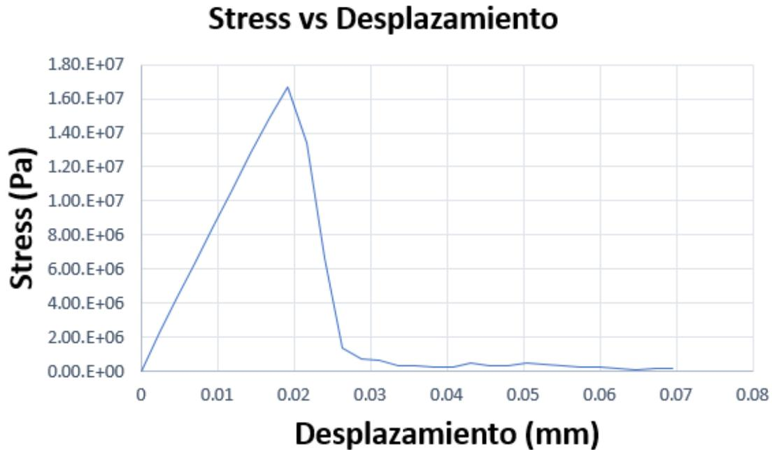
*Figura 14.* Curva Stress-Desplazamiento para el modelo equivalente homogéneo. El valor máximo de stress alcanzado es de 16.7 MPa, sobreestimando la capacidad de la muestra.
