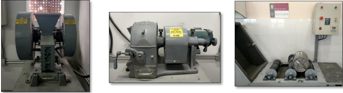
Figura 3.9. Circuito de equipos de reducción de tamaño para el mineral de estudio
