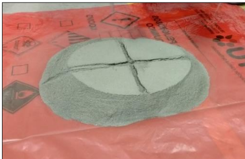
Figura 3.10. Diferencia de tamaño del mineral después de los procesos de chancado y molienda
