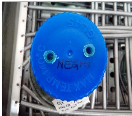
Figura 3.15. Tapa de botella con perforaciones para el ingreso de oxígeno
