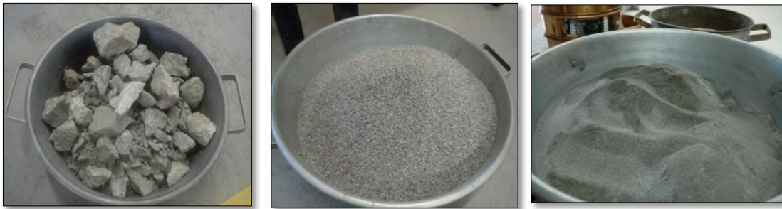
Figura 3.10. Diferencia de tamaño del mineral después de los procesos de chancado y molienda
