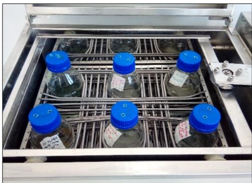
Figura 3.16. Montaje de botellas en agitador termo calefaccionado
