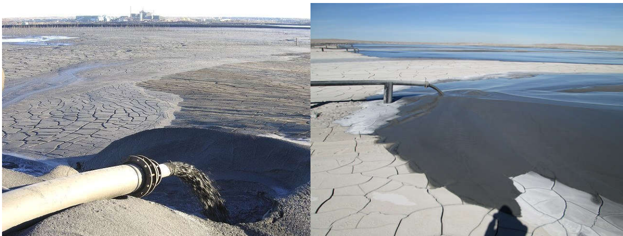
Ilustración 2.4: Depositación de relave FUENTE: ( Minería Chilena, 2015 )
