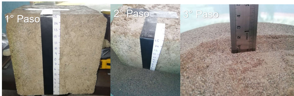
Anexo 13, ensayo de hundimiento con humedad de 5%
