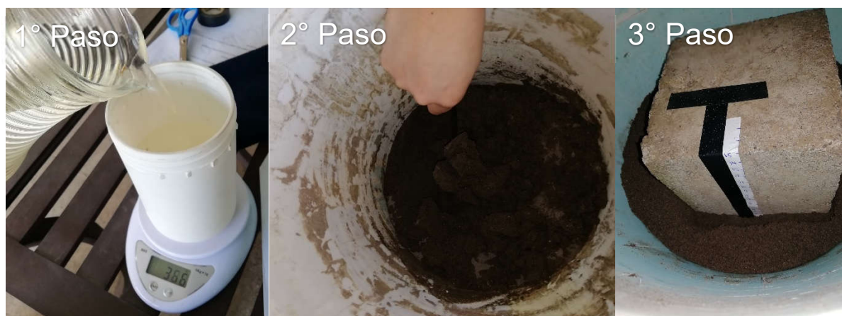
Anexo 13, ensayo de hundimiento con humedad de 5%
