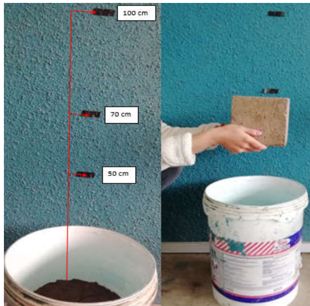
Ilustración 3.1: Esquema de cómo se dejó caer el bloque de concreto, elaboración propia
