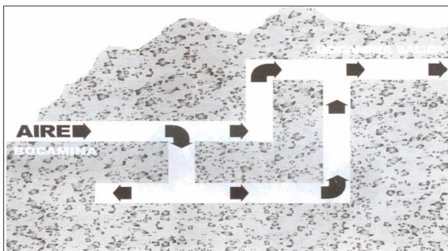
Ilustración 2 Ventilación natural (Gallardo, 2008)
