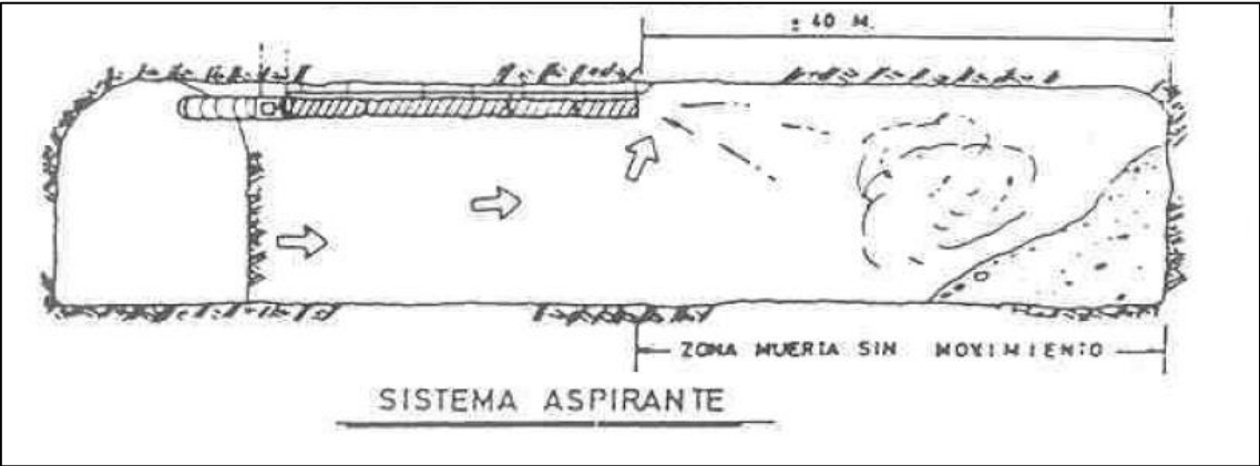
Ilustración 4 Sistema aspirante (Gallardo, 2008)
