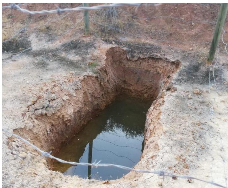
Figura 4-36: Corte Vertical Calicata en suelo de fundación
