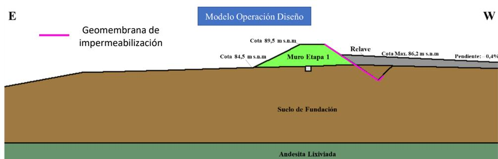
Figura 4-20: Modelo embalse de relaves año 2010 para operación según diseño (Perfil A) (Elaboración Propia)
