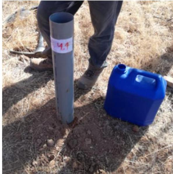
Figura 2-17: Punto 8, ensayo infiltración directa en área circular
