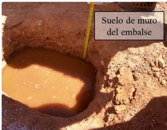
*Figura 2-18: Punto 5, ensayo Porchet
