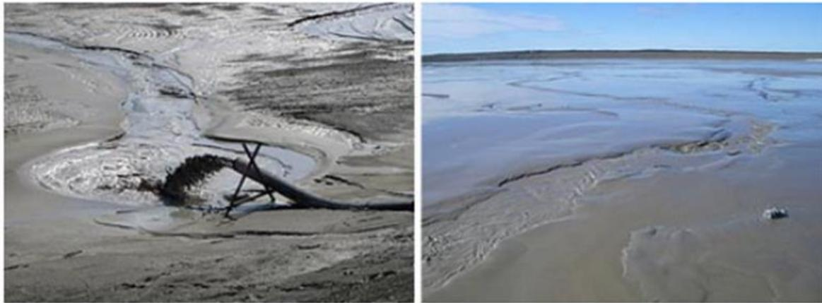
Figura 2-2: Descarga de relaves subaéreas y corrientes superficiales de baja velocidad trenzadas en una playa de colas. (Engels, Gonzalez, Aedo, & McPhail, 2018).
