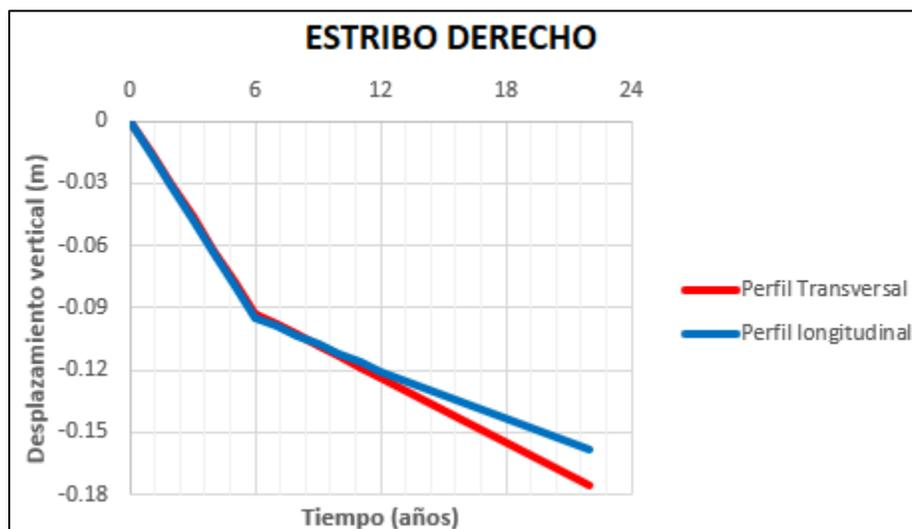
Figura 4.42. Gráfica comparativa de los asentamientos en el estribo derecho entre ambos perfiles, MIDAS GTS NX.
