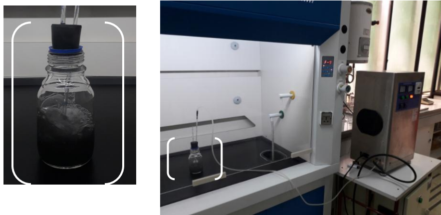
Figura 3.4. Montaje del sistema de acondicionamiento con gas ozono (elaboración propia)
