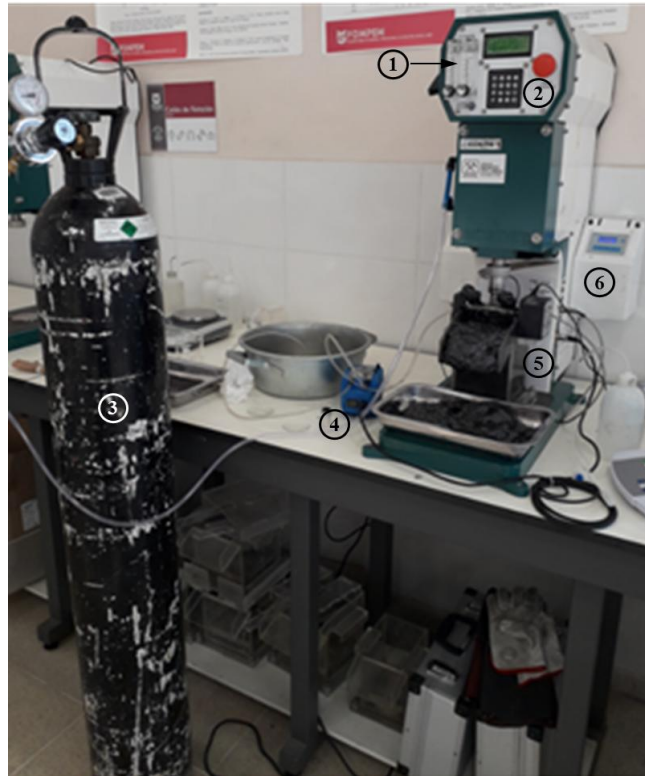
Figura 3.6. Montaje experimental para las pruebas de flotación masiva en celda EDEMET. 1) Fluómetros; 2) controlador automatizado; 3) cilindro de nitrógeno; 4) bomba de reposición de nivel; 5) celda acrílica; 6) medidor de pH (elaboración propia)
