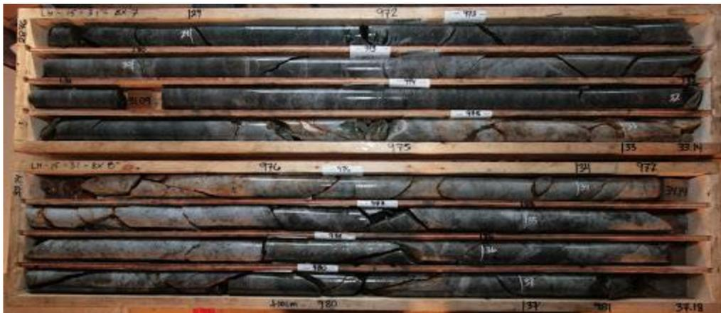
Fotografía 1 Sondajes diamantino almacenado en la caja porta testigos. Recuperado de: <https://www.induambiente.com/especial/mineria/impactos-de-exploracion>
