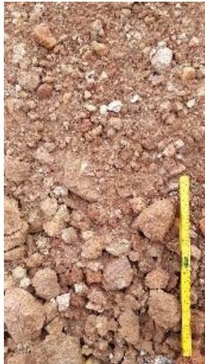
*Figura 7.25 Material del suelo de fundación.*
