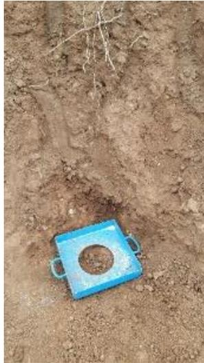
*Figura 7.24 Preparación del terreno para ensayo de densidad in situ.*
