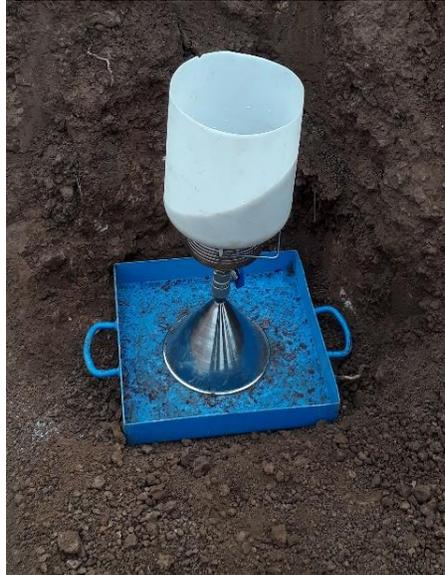
Figura 4.13 Ensayo de densidad *in situ* coluvio ladera (Elaboración propia).
