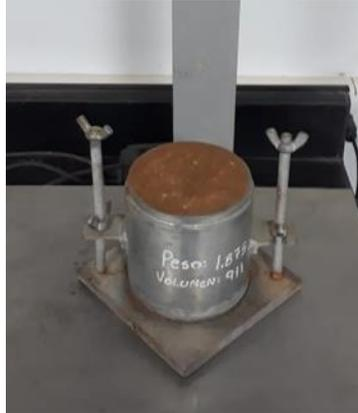
Figura 4.14 Material compactado durante ensayo Proctor modificado.
