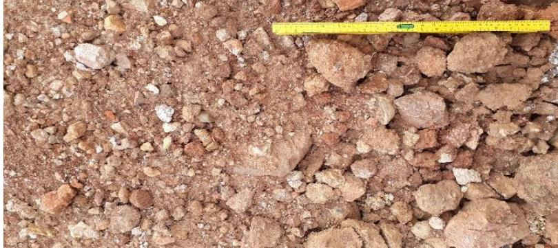
Figura 4.23 Material del suelo de fundación in situ (Elaboración propia).
