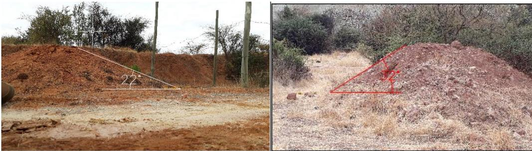
Figura 4.17 A la izquierda medición en terreno de ángulo de reposo material suelo cuyo valor es  $22^\circ$  a la derecha medición en terreno de ángulo de reposo material suelo cuyo valor es  $32^\circ$  (Elaboración propia).
