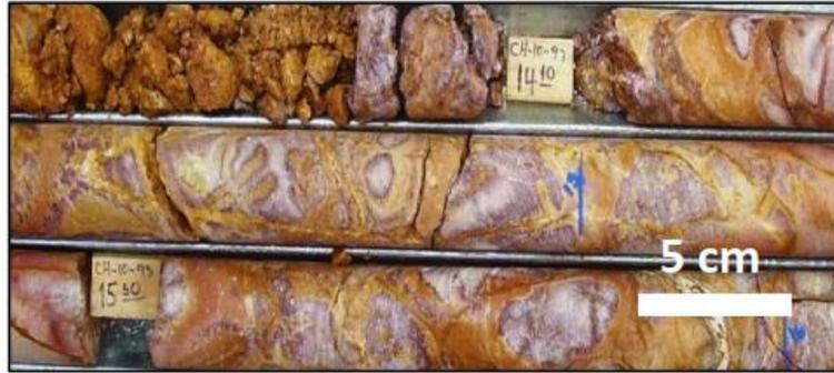
Figura 4.24 Andesita lixiviada, Sondaje mina Colin (Rivas, 2015).
