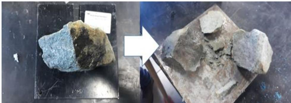
Figura 4.19 Roca pre y post ensayo de compresión simple, con una fractura vertical sin rotura de matriz (Elaboración propia).
