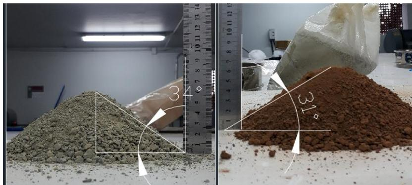
Figura 4.15 A la izquierda, montículo formado por material estéril cuyo ángulo de reposo es de 34°. A la derecha montículo formado por suelo cuyo ángulo de reposo es de 31° (Elaboración propia).
