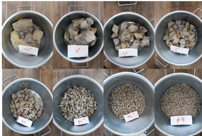
Figura 4.11 Clasificación material estéril inferior a 3 pulgadas y superior a la malla #4 (Elaboración propia).
