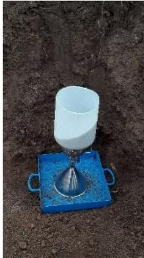
Figura 7.23 Instalación cono de arena para ensayo de densidad in situ coluvio de laderas.
