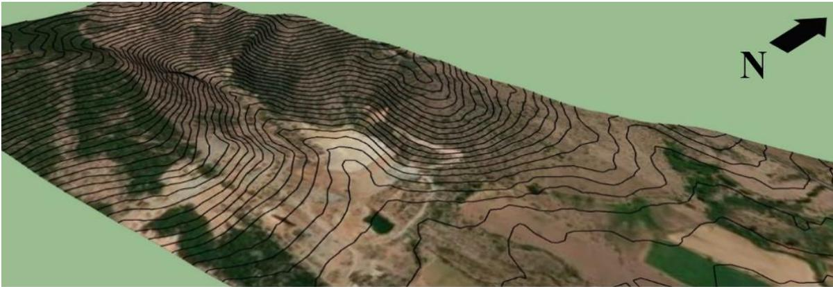
Figura 4.5 Vista tridimensional topografía de la superficie de mina Chépica en dirección NW, al centro se puede observar el depósito de relave, con curvas de nivel cada 5 metros de elevación. (Elaboración propia).
