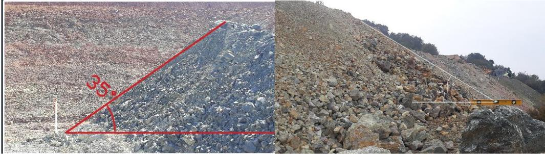
Figura 4.16 A la izquierda medición en terreno de ángulo de reposo de material estéril cuyo valor es  $35^\circ$  a la derecha medición en terreno de ángulo de reposo de material estéril cuyo valor es  $31^\circ$  (Elaboración propia).
