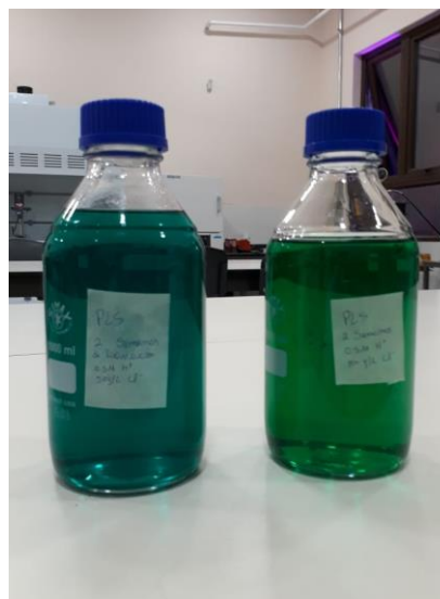
Figura 4.7: PLS, 2 semanas de lixiviación, izquierda; 50 g/L Ct con 0.5 M H + , derecha; 100 g/L Ct 0.5 M H +
