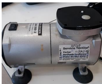
Figura 3.4: Bomba de vacío
