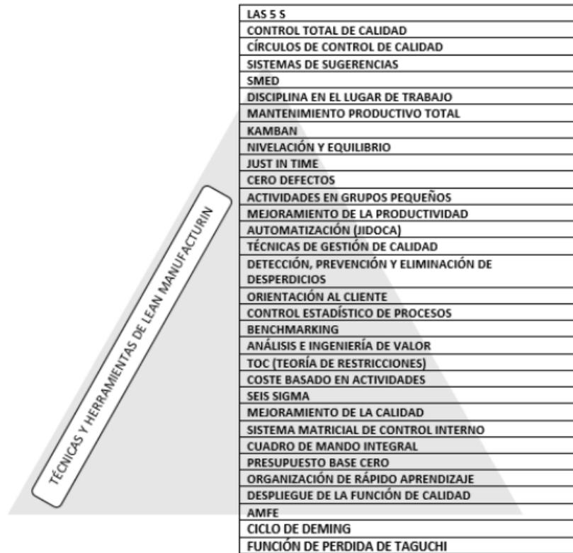
Figura 2 Técnicas y herramientas de Lean Manufacturin
