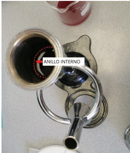
Figura 3.3. Anillo interno del caldero cónico del ebulómetro.
