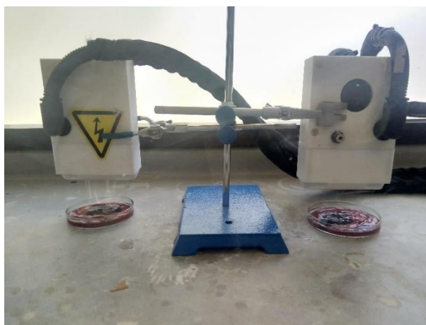
Figura 3.2. Ejemplo del tratamiento de orujo de uva cv. Cabernet Sauvignon expuesta a la aplicación de plasma frío atmosférico (PFA).
