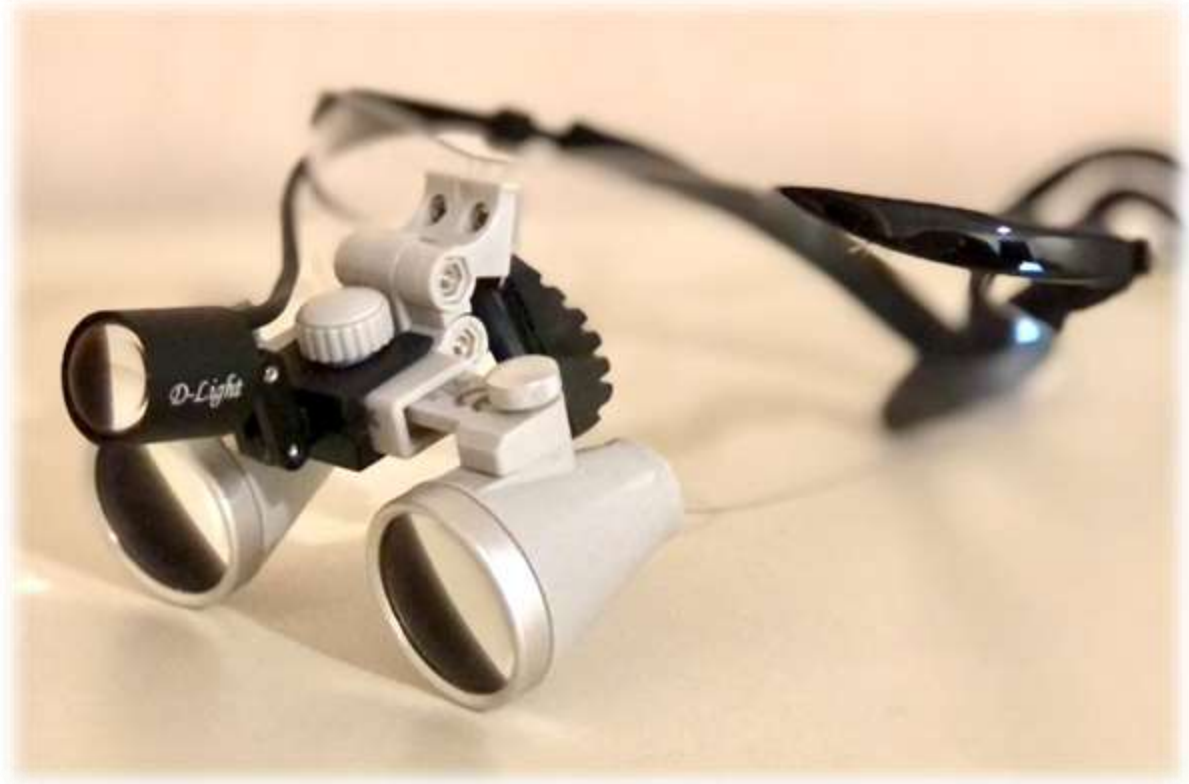
Figura 1.b Lupa Flip up con Sistema Galileano. Su barril es cónico y se puede voltear hacia arriba cuando no se requiere aumento.
