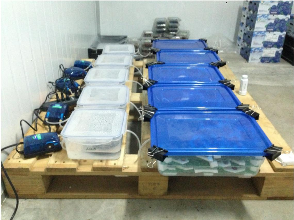
**Anexo 6.** Sistema de impulsión de aire conectado a contenedor con diferentes concentraciones de agua/glicerol, las cuales generaban las condiciones de humedad relativa en caja donde se encontraba contenida la fruta.
