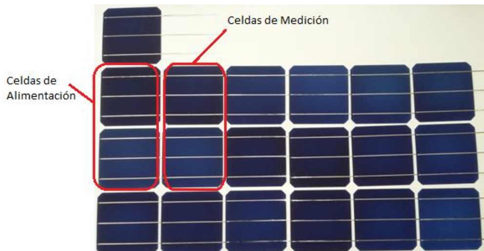
Figura 4.7 Conexionado del arreglo fotovoltaico
