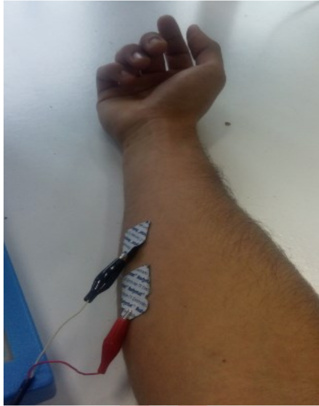
Figura 36. Toma de señales EMG con electrodos de superficie en el antebrazo.
