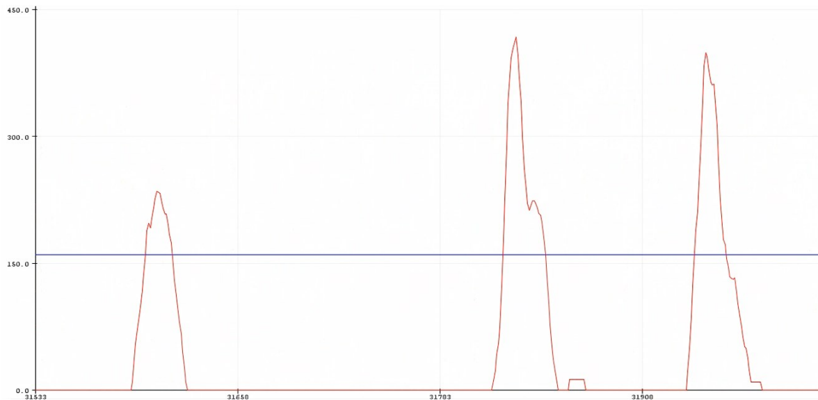
Figura 37. Gráfica de señal EMG en el antebrazo con circuito montado en protoboard.
