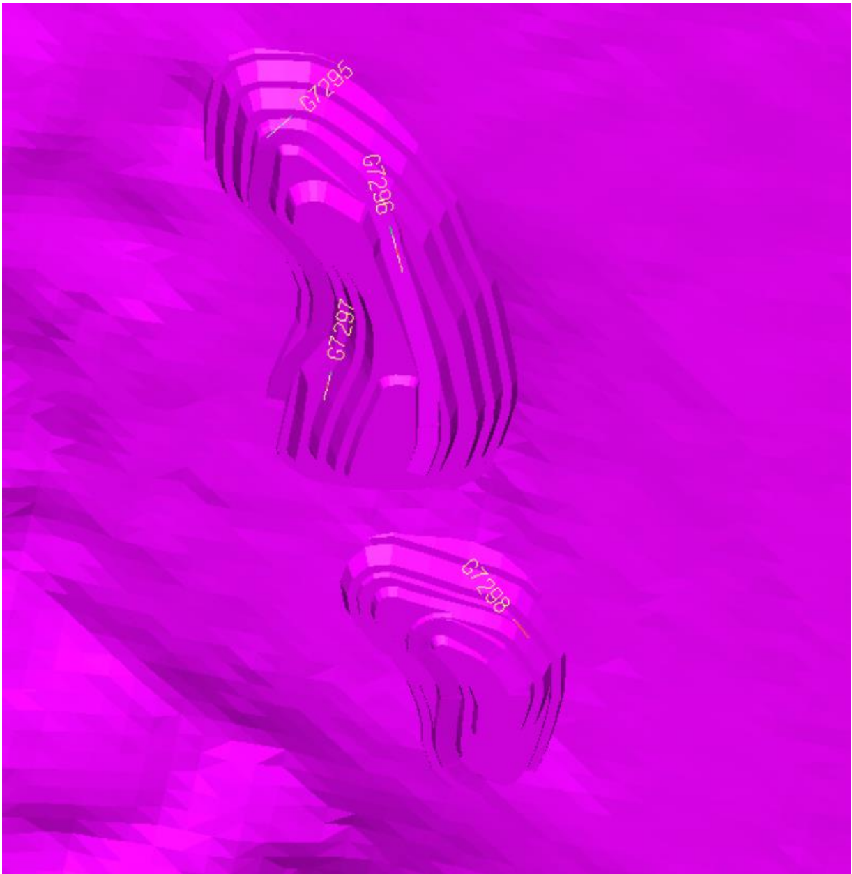
FIGURA A. 2: Visualización de collares de los sondajes perteneciente al sector Tailandia, en la parte superior se encuentra el rajo Tailandia 1 y en el inferior el rajo Tailandia 2.
