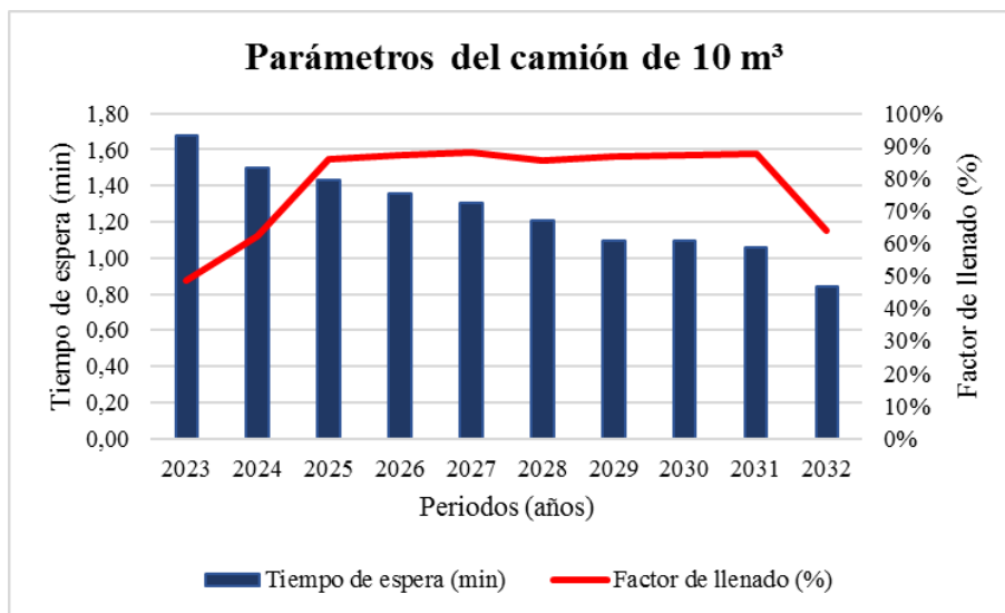
Figura 5.20: Parámetros del camión de 10 m 3
