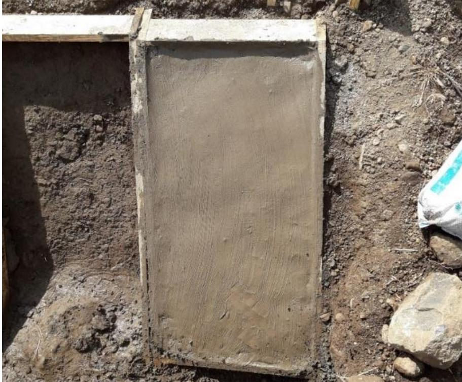
*Ilustración 31: Talud con un 12 % de cemento.*
