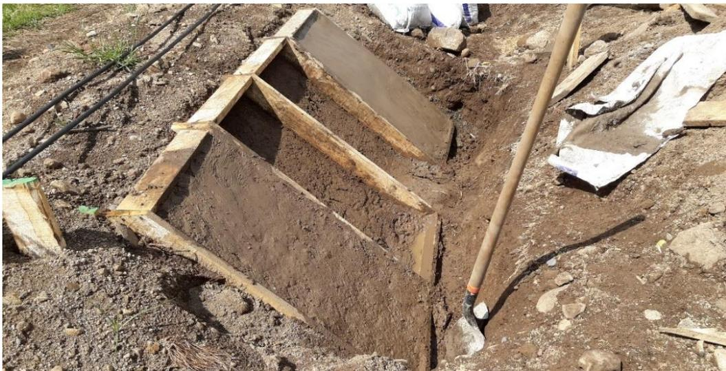
*Ilustración 32: Talud con suelo compactado y talud con 12 % de cemento.*
