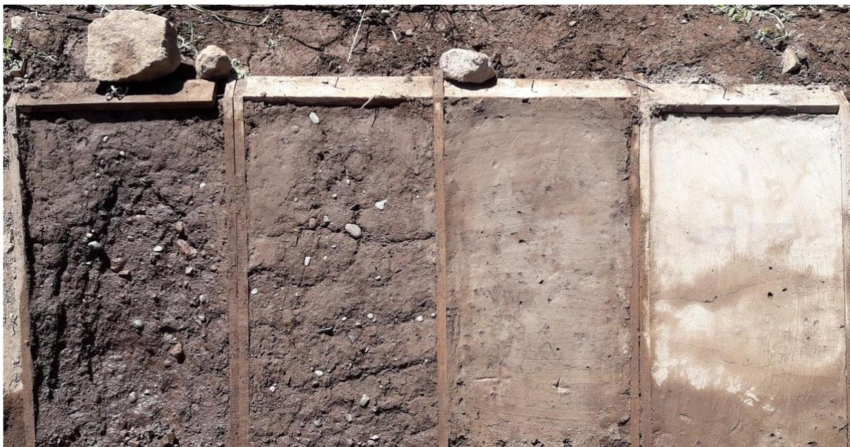
*Ilustración 42: Resultado de ensayo de erosión para un período de retorno de 10 años.*
