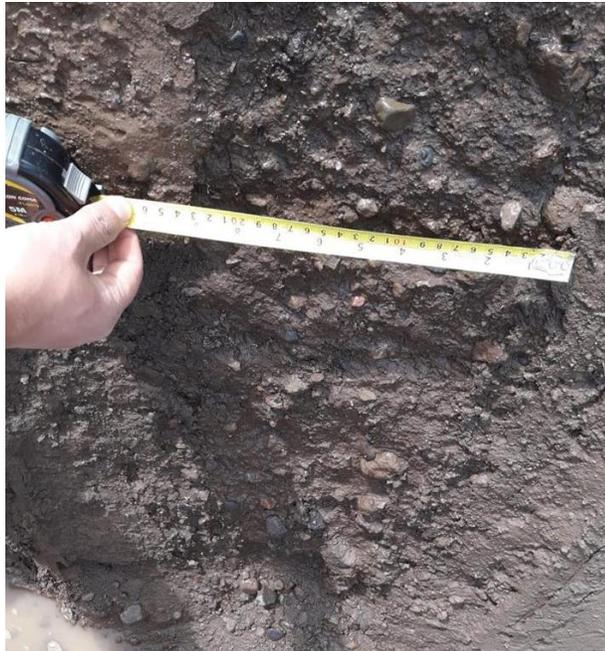
*Ilustración 37: Ancho de erosión del talud 1 (0 % de cemento añadido).*
