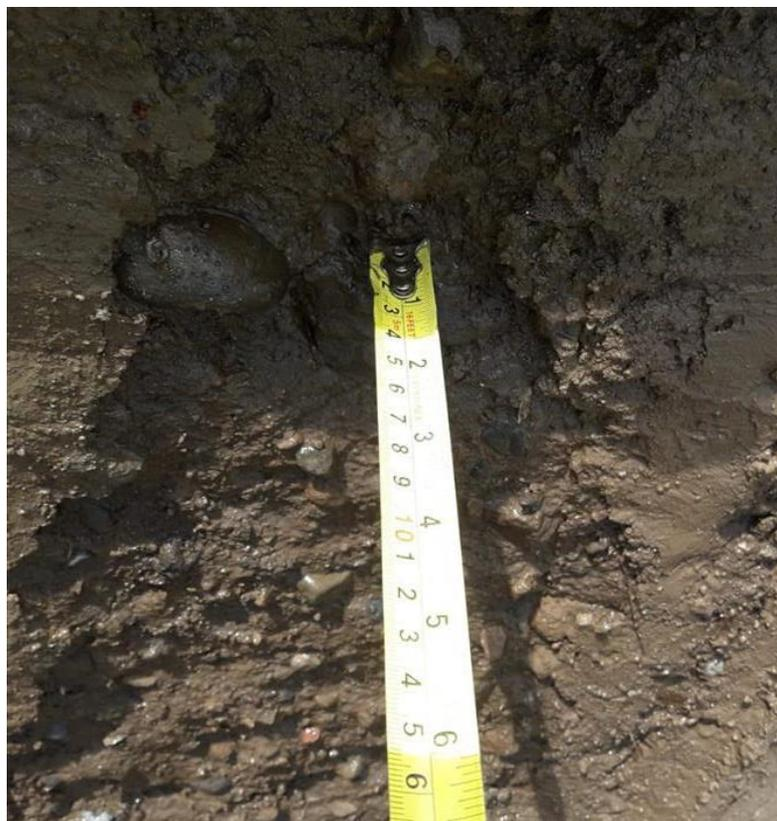
*Ilustración 36: Profundidad de erosión del talud 1 (0 % de cemento añadido).*
