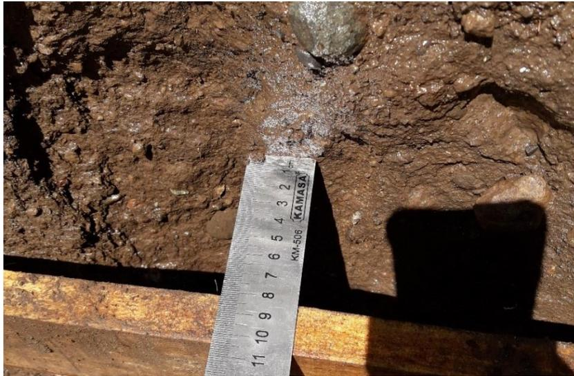
*Ilustración 43: Erosión en el talud 1 para 10 años de período de retorno.*
