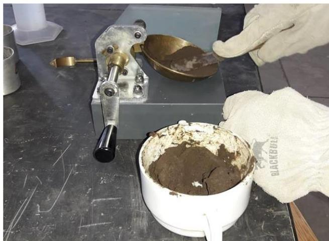
*Ilustración 22: Ensayo de límite líquido.*
