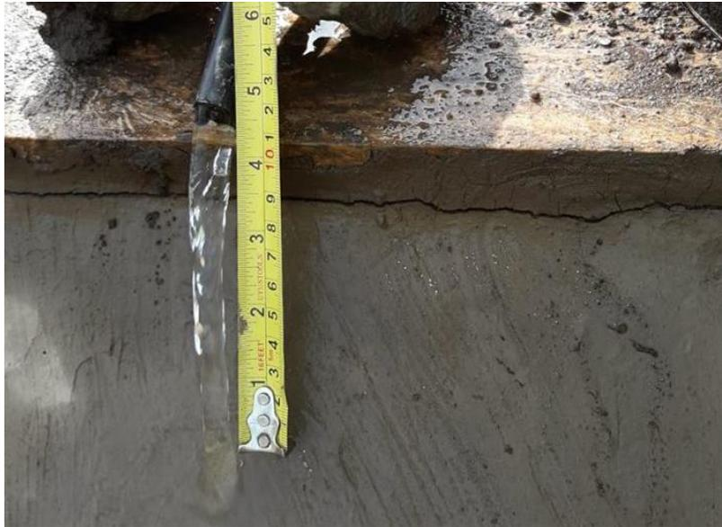
*Ilustración 35: Ensayo de erosión del talud con 12 % de cemento.*
