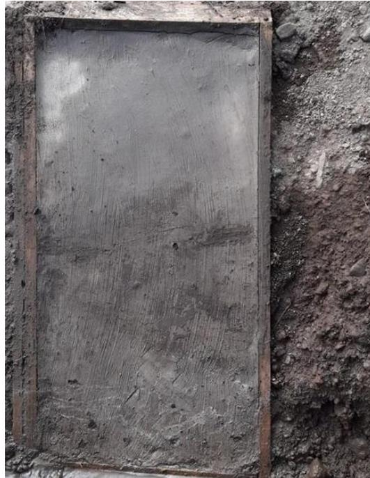
*Ilustración 41: Talud con 12 % de cemento luego del primer ensayo.*
