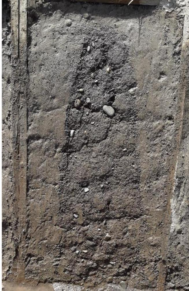
*Ilustración 39: Daño en el talud 2 (6 % de cemento añadido).*
