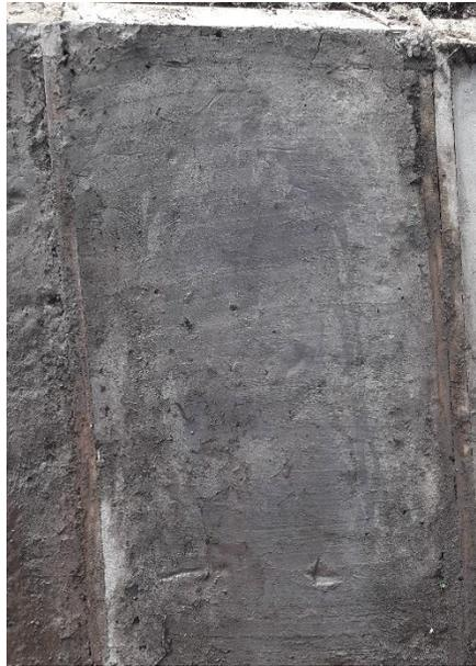
*Ilustración 40: Talud con 9 % de cemento al final del primer ensayo.*
