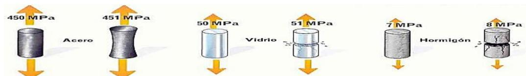
Imagen 33 / Resistencia a tracción.
