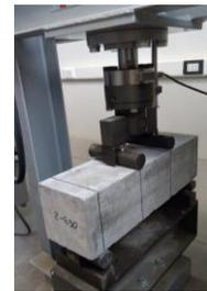
Imagen 62 / Flexotracción
