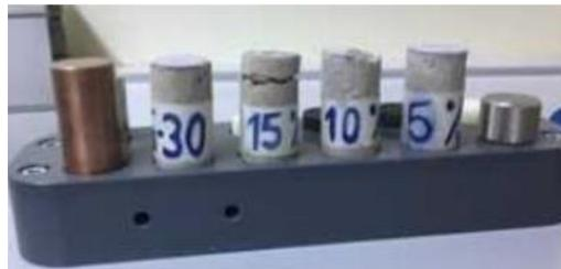
Imagen 85 / Probeta para conductividad térmica.
