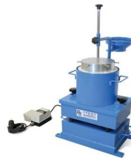
Imagen 14 / Consistómetro Vebe.
