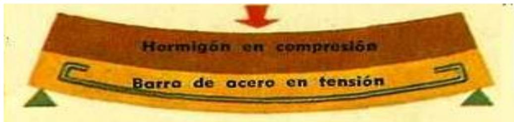
Imagen 11 / Hormigón armado.
