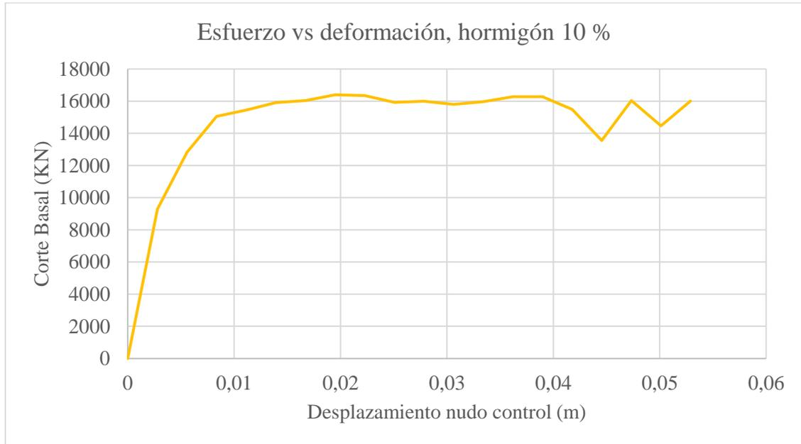
Gráfico 23 / Esfuerzo vs deformación, hormigón 10 %.
