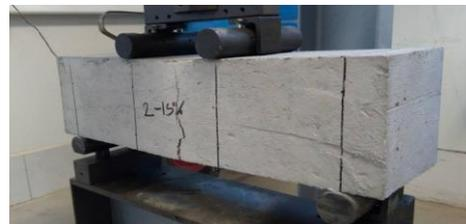
Imagen 83 / Probeta prismática (15 %).
