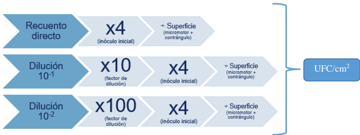
Figura 6: Esquema con pasos a seguir para el cálculo de RAM en unidades formadoras de colonia por cm 2 .
