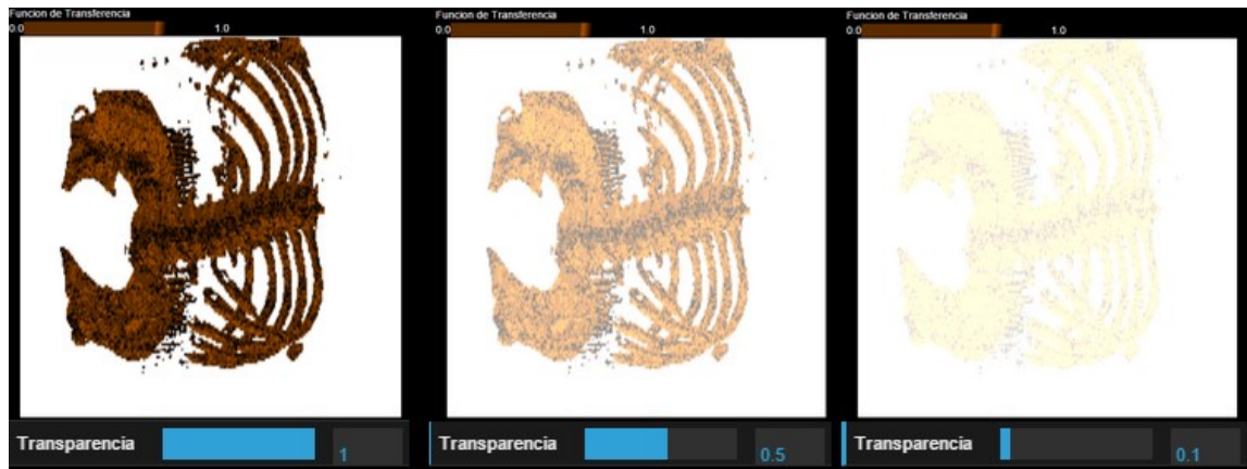
Figura 4.24: Filtro de transparencia en visualización de 3 dimensiones.
