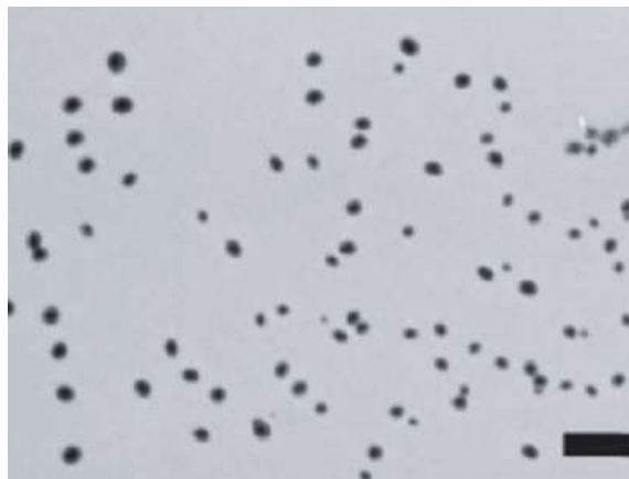
FIGURA 5.6: Muestra de colonia real tomada desde un microscopio electrónico, contiene 82 colonias.
