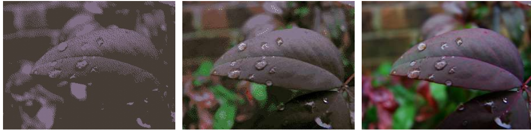
FIGURA 2.4: Una profundidad de color diferente para una misma imagen genera estos resultados, de izquierda a derecha tenemos la imagen representada con 1 bit, 4 bits y 32 bits.
