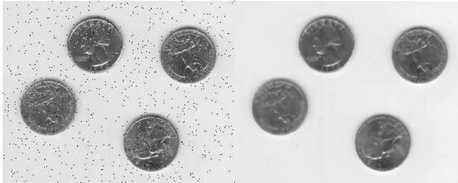
FIGURA 2.8: Filtro de mediana aplicado en una imagen que presenta ruido del tipo Sal y Pimienta.
