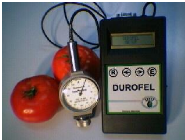
Figura 3.3: Equipo Durofel®. Cuenta con un vástago en el cuál se ve la medición de la firmeza y una teclera en la cual se configura el aparato y se visualizan las mediciones exactas de firmeza.
