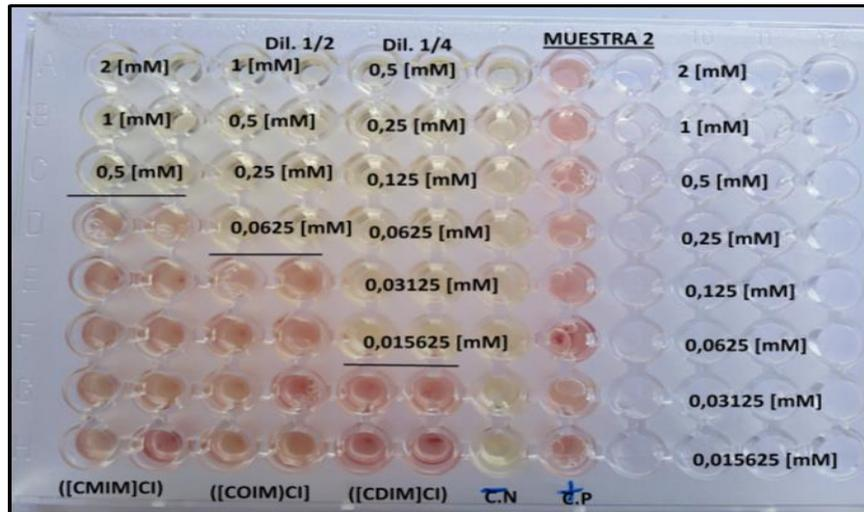
**Figura 8.** Microdilución en caldo utilizada para la determinación de la CMI de las sales derivadas del *N*-cinamilimidazolio en la muestra N°2 de *S. mutans*. ([CMIM]): *N*-Cinamil-metilimidazol, ([COIM]Cl): *N*-Cinamil-octilimidazol ([COIM]Cl) y *N*-Cinamil-decilimidazol ([DCIM]Cl), C.N: control negativo, C.P: control positivo.
