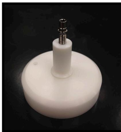
Figura N°4: Plataforma de teflón con el montaje de la muestra para micro-CT
