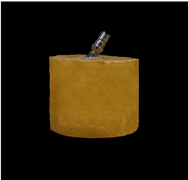
Figura N°2: Montaje de la muestra en cilindro de acrílico autopolimerizable en 30°
