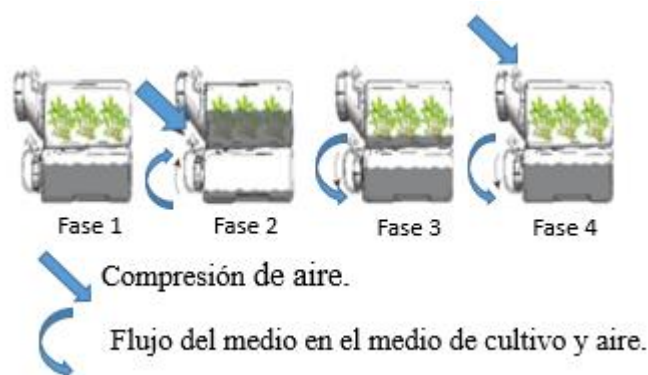
Figura 2: Esquema del mecanismo de acción del sistema SETIS (Vervit 2013). Fase 1: Fase estacionaria; Fase 2: Fase inmersión; Fase 3: Fase finalización de la inmersión; Fase 4: Fase ventilación.
