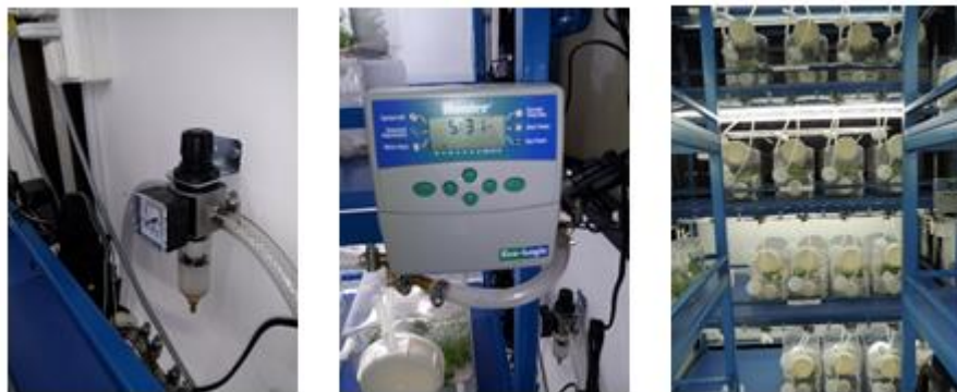
Figura 1 válvulas, programador y SETIS.
