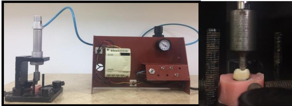
**Fig 5. Máquina de carga axial.**
