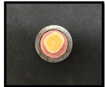
Fig. 3: Confección de la probeta de acrílico.
