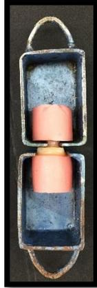
Fig. 16: Probeta colocada en cajas metálicas
