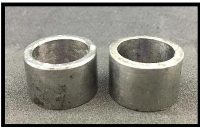
Fig. 2: Cilindros de acero inoxidable, que sirvieron de molde para la confección de las probetas de acrílico.
