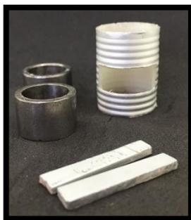
Fig. 12: Sistema de cilindros para la confección de probeta
