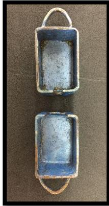
Fig. 15: Cajas metálicas para colocar la probeta
