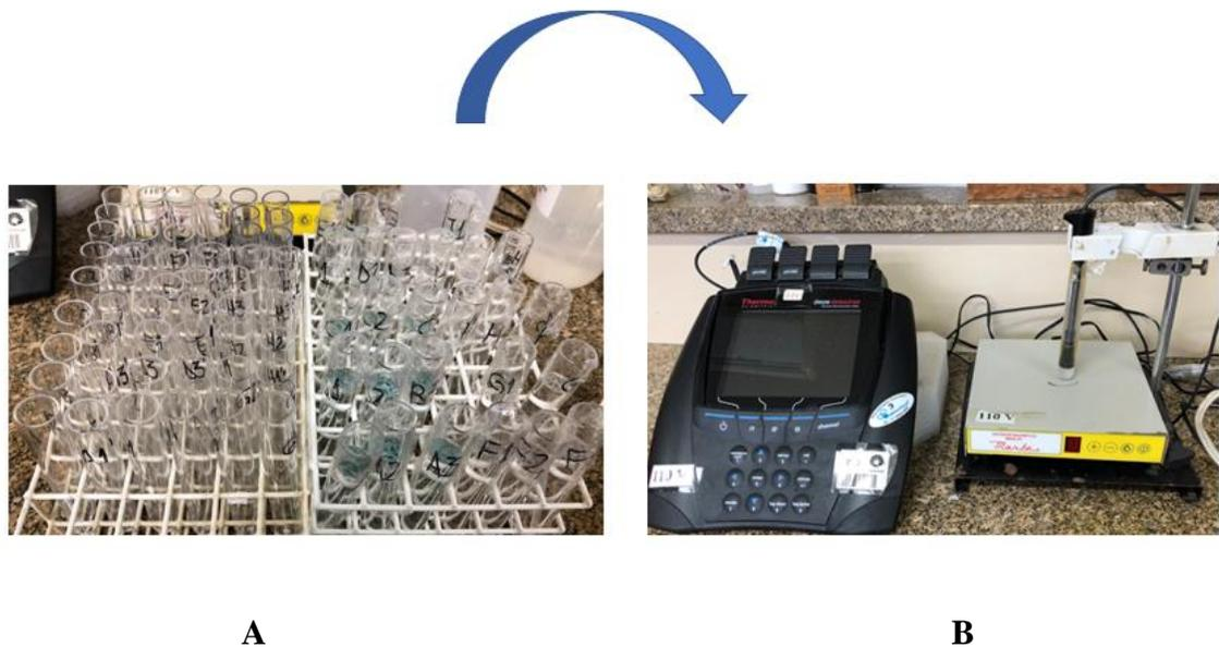
**Figura 8: Análisis de muestras.** A) Tubos de ensayo con las muestras ya diluidas, preparadas para la lectura con el EIE. B) EIE acoplado a analizador de iones utilizado para el análisis de las muestras.
