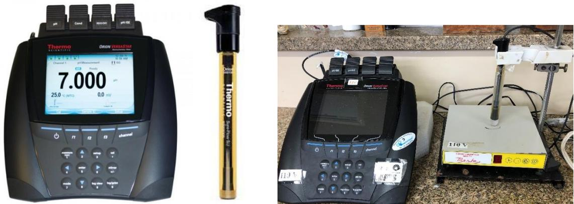
**Figura 5: Analizador de iones, electrodo ion específico combinado y EIE acoplado a analizador de iones.**
