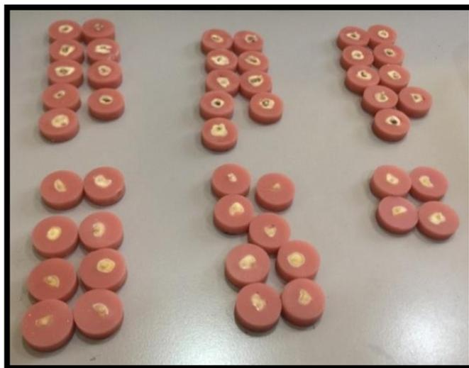
Figura 25. Muestras de cizallamiento montadas en acrílico.
