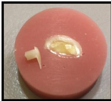
Figura 32. Muestra posterior a aplicación de prueba de resistencia al cizallamiento.
