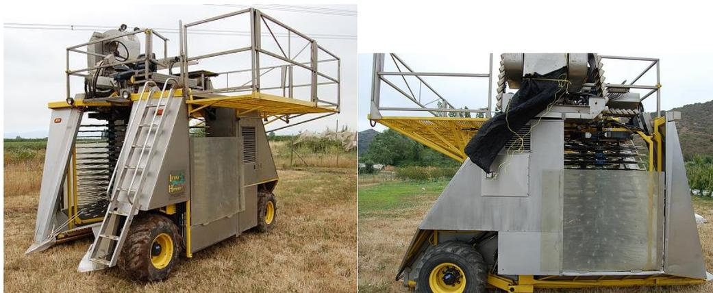
**Figura 3.2 Detalles de la máquina Littau Harvester modelo over-the-row.**
