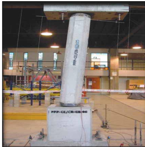
Imagen 28: Disipador de energía autocentrante tipo biela.
