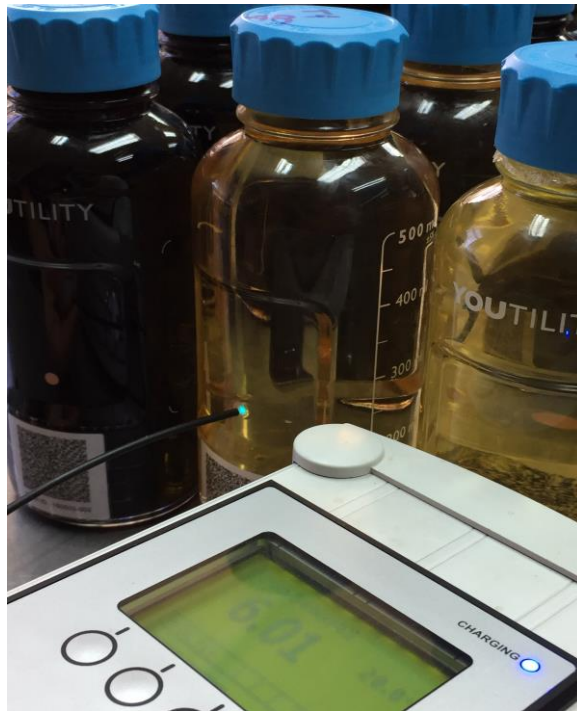
Figura 1. Medición de oxígeno disuelto con analizador NomaSense
