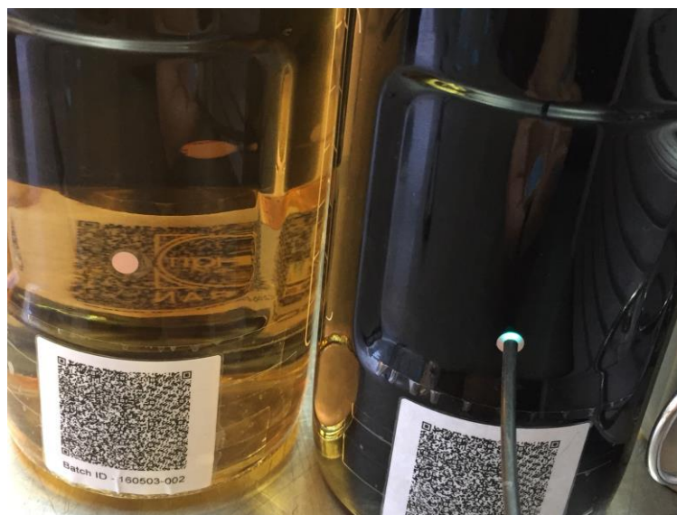
Figura 2. Medición de oxígeno disuelto con analizador NomaSense.
