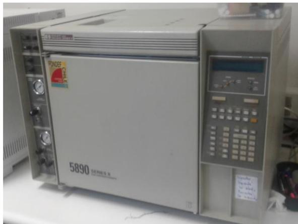
**Figura 3.2.2:** Cromatógrafo de gases
