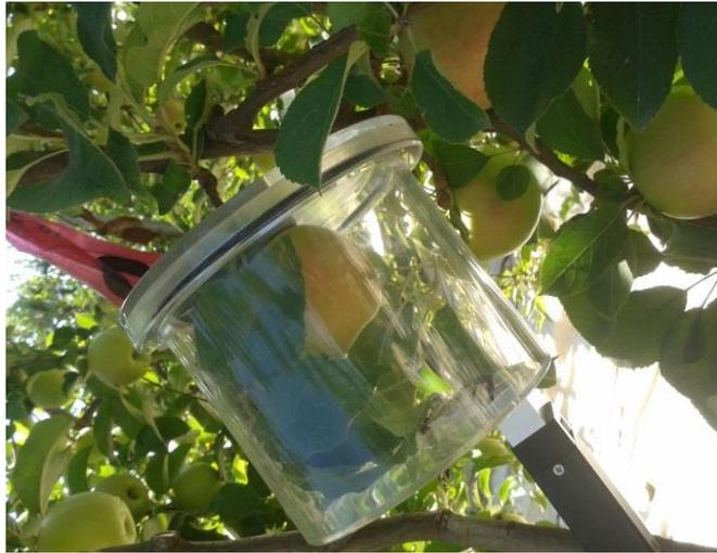
**Figura 3.2.1:** Analizador de etileno portátil en campo.
