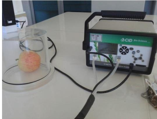
**Figura 3.3.1:** Analizador de etileno portátil, en laboratorio.
