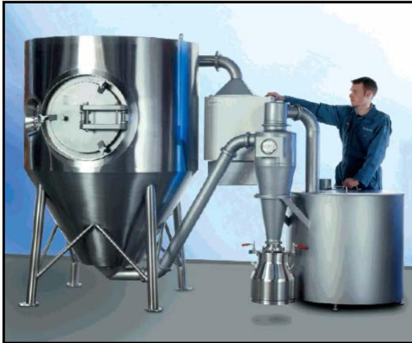
Figura N°8: Secador en Aerosol
