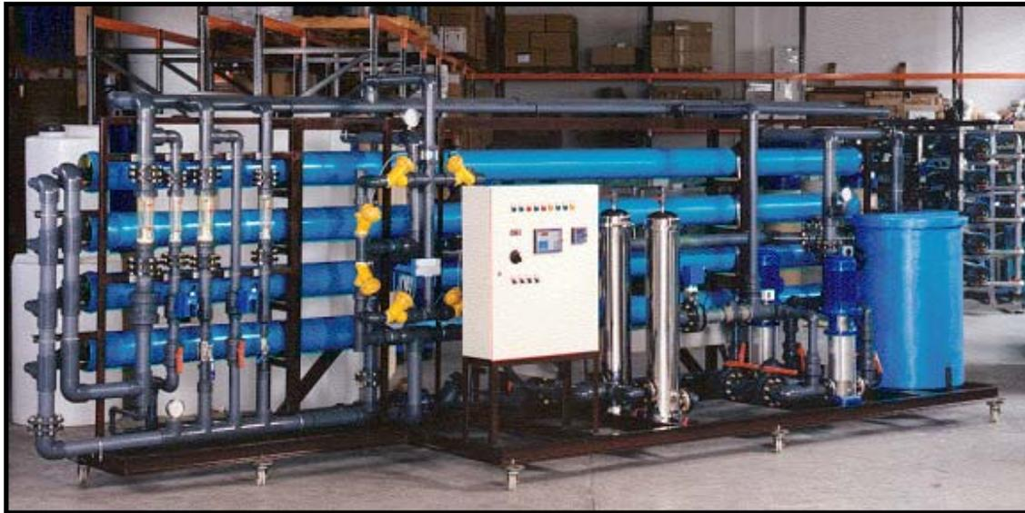
Figura N°7: Nanofiltración
