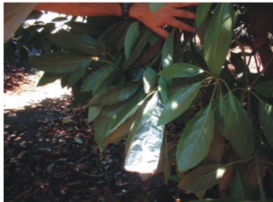
Foto 26 (arriba). Técnico operando cámara de presión y (abajo) hoja de palto tapada con papel aluminio para bloquear la transpiración de la hoja, previo a la medición del potencial hídrico xilemático.
